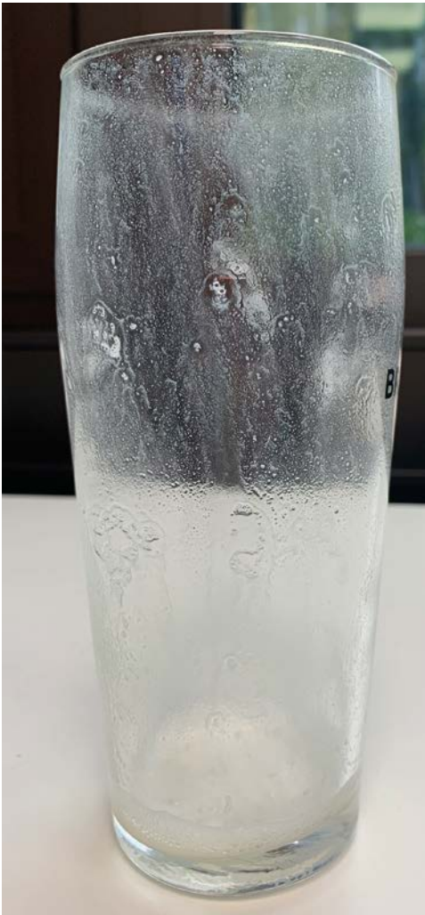
Testanschmutzung der Glasinnenseiten mit einer Bakteriophagensuspension im Labor
