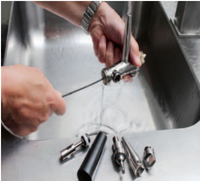
Abb. 5: Zur gründlichen Reinigung zerlegte Zapfhähne für Bier (links) und Postmix (rechts)
