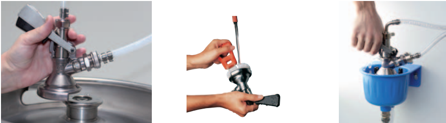
Abb. 3: links: kritischer Bereich (Anschluss des Zapfkopfes an den Getränkebehälter), Mitte: Reinigung des Zapfkopfes mit Trinkwasser und Bürste, rechts: Reinigung des Zapfkopfes mit einer Zapfkopfdu- sche Spülen des Hahnauslaufes und der Luftbohrung mittels Reinigungsball
