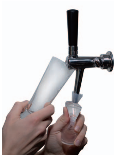
Abb. 2: Spülen des Hahnauslaufes und der Luftbohrung mittels Reinigungsball
