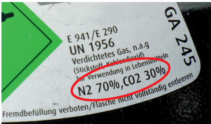
Abb. 2: Beschriftung einer Druckgasflasche mit Mischgas mit 70 % N 2 und 30 % CO 2 -Anteil
