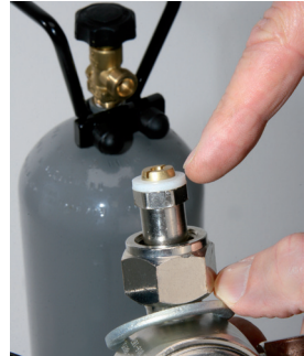
3. Dichtung am Druckminderer kontrollieren. Verformte oder defekte Dichtungen dürfen nicht verwendet werden. Auf die korrekte Passform der Dichtung ist zu achten.
