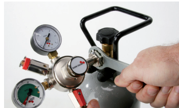
5. Druckminderer mit geeignetem Gabel- oder Ringschlüssels festziehen. Rohrzan- gen sind hierzu ungeeignet. Zu kräftiges Anziehen der Überwurfmutter schadet der Dichtung.
