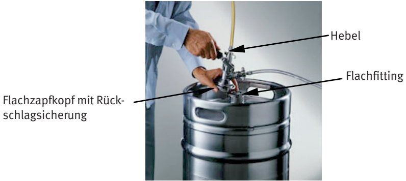
Abb. 9: Keg-Anschluss mit Flachfitting
