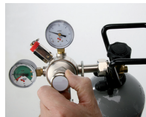
7. Wenn erforderlich den Betriebsdruck nachstellen
