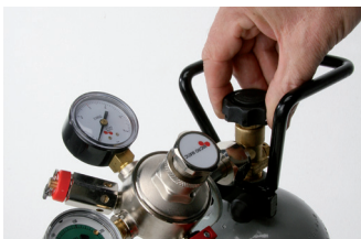
6. Druckgasflasche vollständig bis zum Anschlag aufdrehen. Nur so ist eine sichere Abdichtung der Druckgasflasche gewährleistet. Danach Absperrhahn am Druckminderer öffnen.
